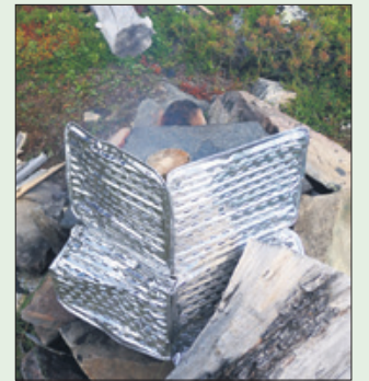
Nitojalla neljä grillausalustaa yhteen ja tuulisuoja on valmis. Kuva: Hannu Tuovinen
